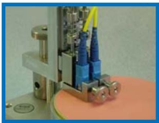
←独立サスペンションにより、数に関らず一貫した研磨品質を保証
